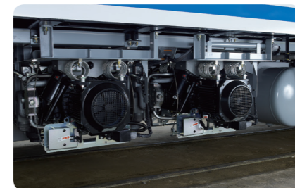
공기압축기 Air Compressor
