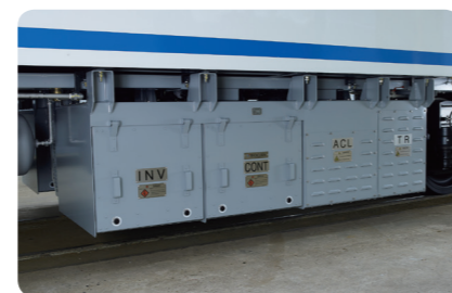
보조전원장치(SIV) Static Inverter 주회로방식 IGBT PWM Inverter 입력전압 1,500Vdc 정격 AC 85kVA
