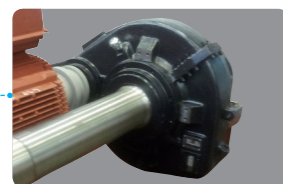
기어박스 Gear Box 정격 165kw 정격회전수 2,250rpm 기어비 1/7.07 출력토크 8,740Nm
